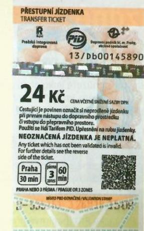
Označovací pole je tvořeno chemicky reagujícími proužky, které způsobí dvoubarevné zabarvení vytisklých údajů po označení. Změna barvy je patrná již 30 sekund až 1 minutu po označení, k úplnému vybarvění dochází přibližně za 5 minut. Údaje z označovače na jízdenkách jsou shodné s údaji uvedenými u jízdenek ze stacionárního automatu. Tyto informace se vztahují ke všem jízdenkám vydávaným v předprodeji.
